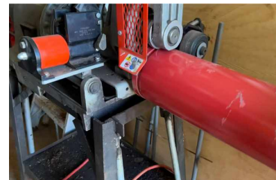
Ranuradora de Tuberías AC.
