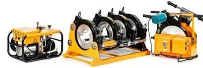
Termo y Electrofundidora de HDPE.
