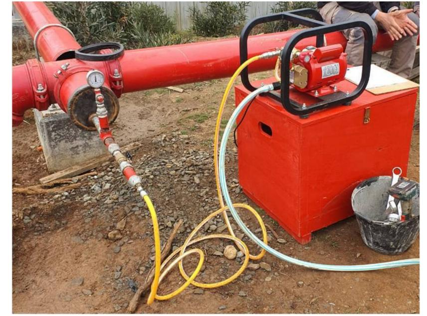
Bomba para pruebas Hidraulicas
